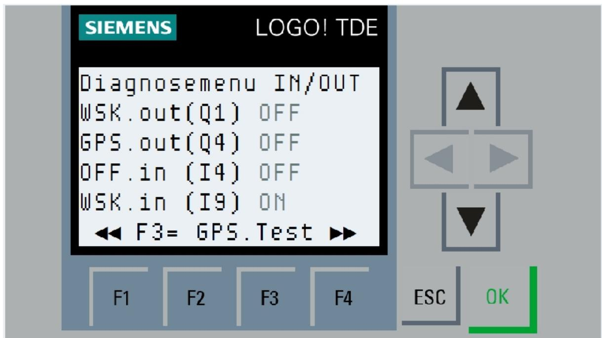
Hier unter anderem Diagnose der EIN- und Ausgänge der Steuerung UND per Tastendruck auf F3 die testweise Ansteuerung der Gaspedalsperre .
