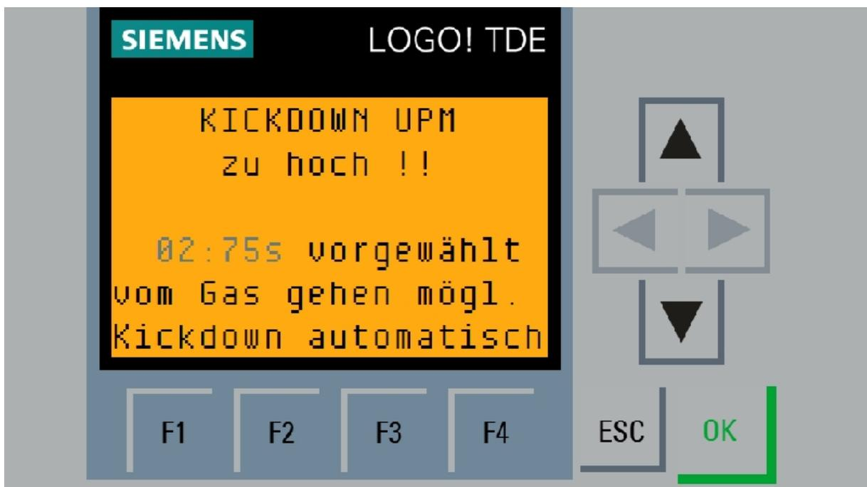
Diese Meldung erscheint wenn der Kickdown betätigt wurde. Die Steuerung besitzt eine Signalverarbeitung die die Genauigkeit des Kickdownschalters verbessert. Weiterhin „merkt“ sich die Steuerung einen Kickdownwunsch über 5 Sekunden (einmal drücken reicht). Sollte man sich innerhalb dieser Zeit im Bereich des eingestellten Kickdownparameters befinden, so schaltet die Steuerung den Kickdown automatisch ein.
