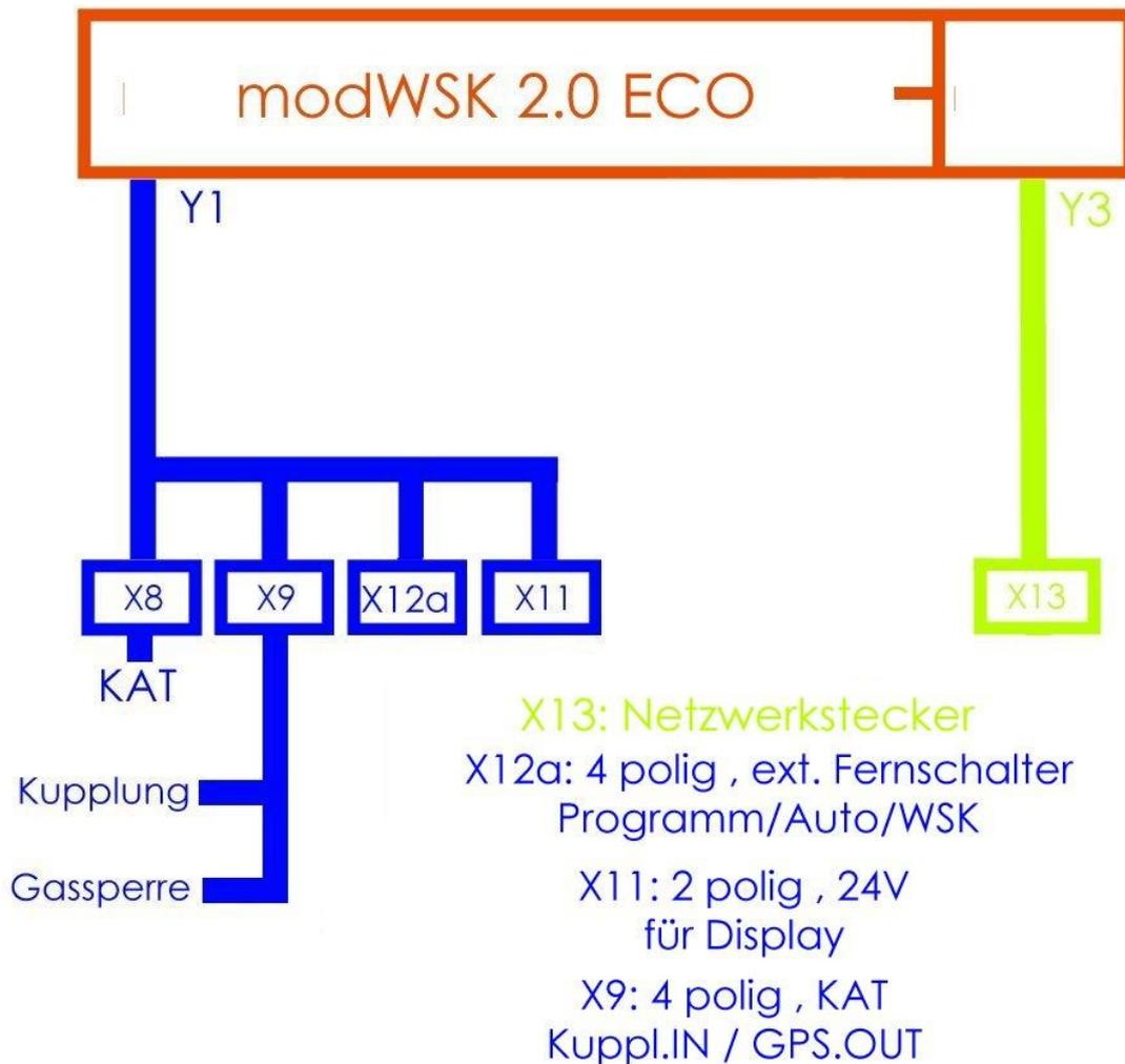
In der ECO Version fehlen alle externen Schalt- und Überwachungsorgane .
