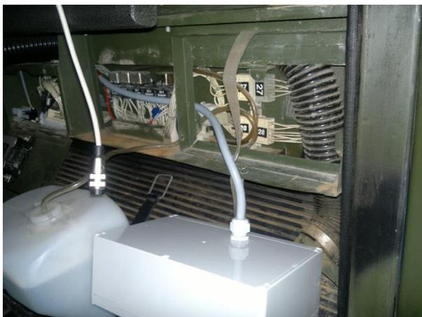
Danach wird das Anschlusskabel der modWSK wie im Bild verlegt. Info: durch Entfernen des ersten Relais geht es besser!
