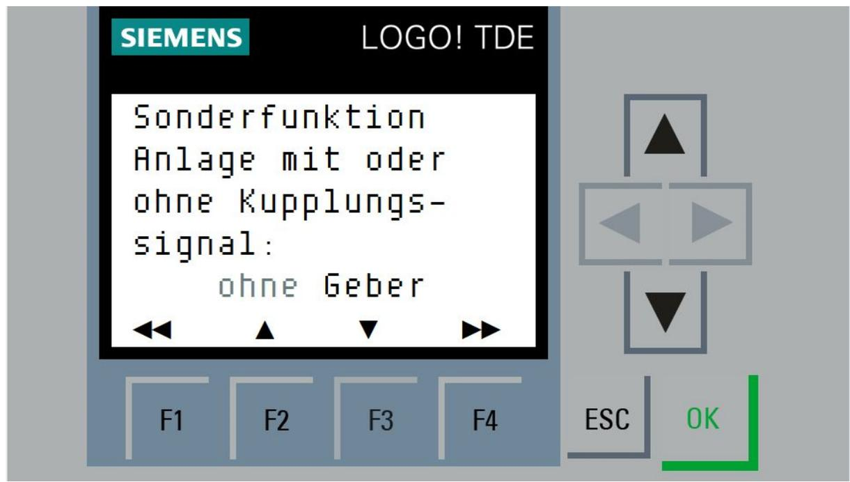
Sollte der Kupplungsschalter defekt sein oder fehlen kann dieser hier ausprogrammiert werden . Dies kann sinnvoll sein um die Schlupfanzeige wieder zu aktivieren da bei einem erkannten defekt diese deaktiviert wird um Fehlanzeigen zu vermeiden .
