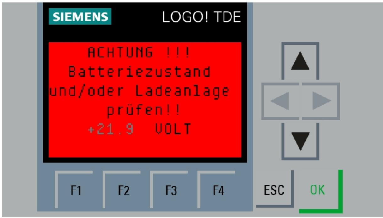
Ladezustand der Batterie bei Einschalten der Zündung: Unter 23V
