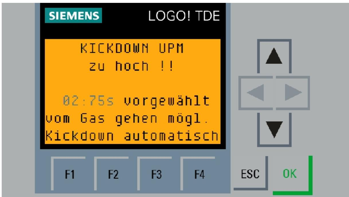
Diese Meldung erscheint wenn der Kickdown betätigt wurde. Die Steuerung besitzt eine Signalverarbeitung die die Genauigkeit des Kickdownschalters verbessert.
