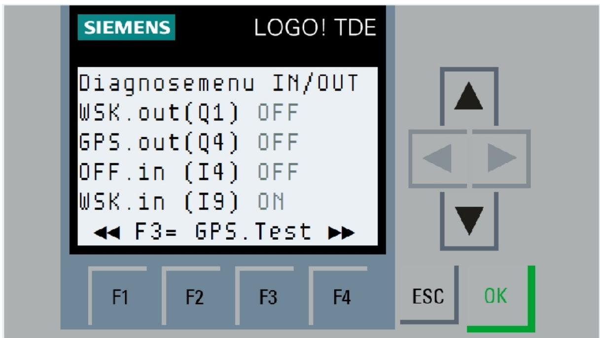
Hier unter anderem Diagnose der EIN- und Ausgänge der Steuerung UND per Tastendruck auf F3 die testweise Ansteuerung der Gaspedalsperre .
