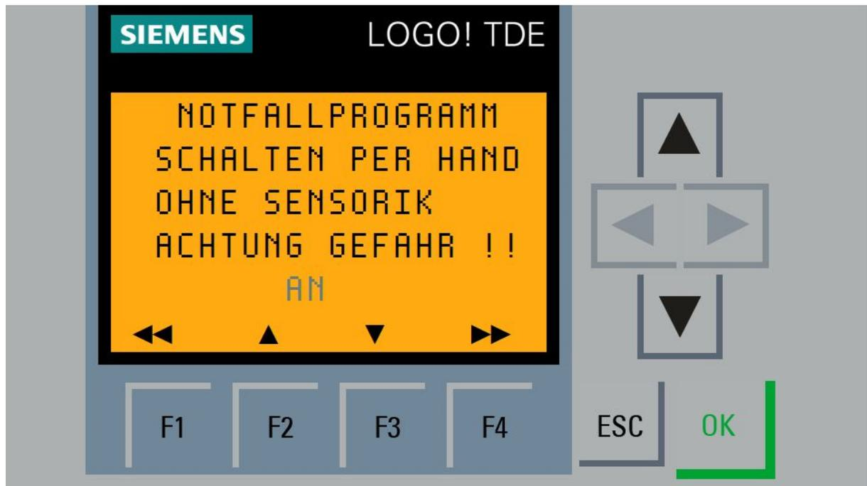
Für den Fall das im Getriebe Sensoren ausfallen ist es ab Softwarestand 2.1.i4 möglich die Steuerung komplett zu deaktivieren ! Wenn dieser Parameter auf AN gestellt wird ist es möglich mit dem HAND-Schalter die Wandlerschaltkupplung HART ein und auszuschalten.
