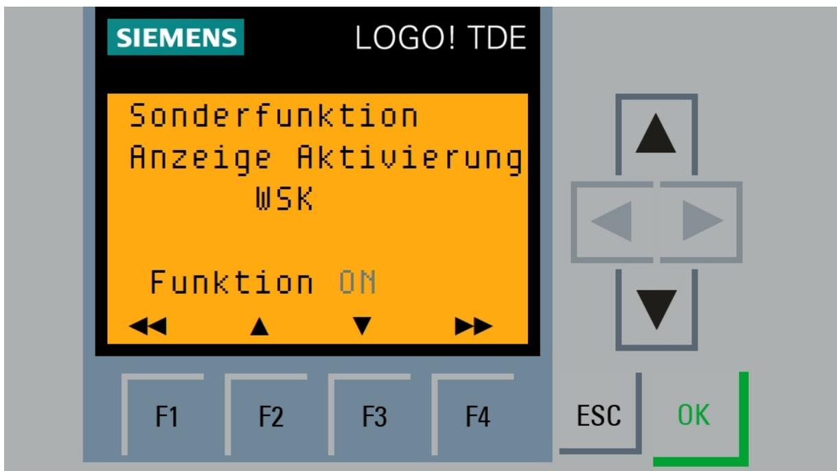
Ist dieser Parameter eingeschaltet so wird beim Einschalten der WSK ein Hinweis eingeblendet. Dies ist nützlich , da zwischen dem Signal „schalte EIN“ und der endgültigen Reaktion des Wandlers ca. 3 sek. liegen .
